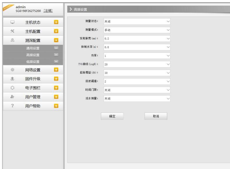
(4) 点击低频设置，把测量状态选择开启，一般情况下，用户选中【自动】测量模式即可，不需要额外调节参数。如果遇到水下环境比较复杂的情况，如较浅水域、水下地形突变较大、水流较急的水域。自动测量不能很好的获取测量结果时，可以使用【手动】测量模式。
