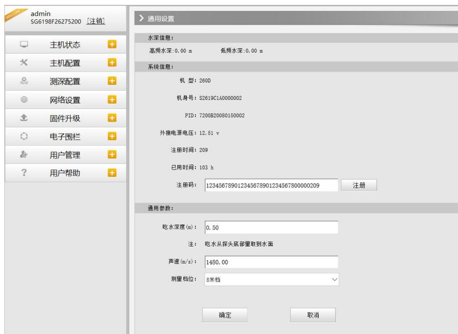
(2) 点击“测深配置”，选择通用设置，设置吃水深度、声速和测量档位，点击确定。
